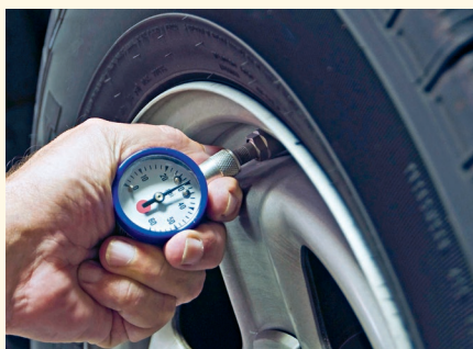
AEC-SPARTIPP: ÜBERPRÜFEN SIE IN REGELMÄSSIGEN ABSTÄNDEN DEN REIFENDRUCK.
